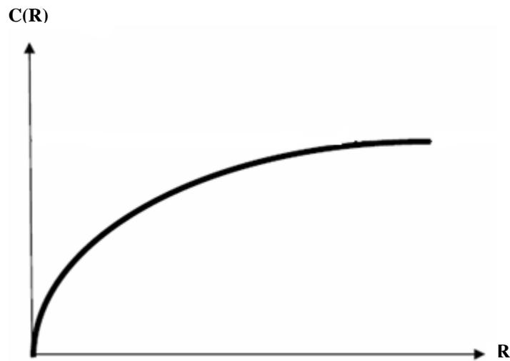
Fig.3.7 Variation du contraste des anneaux de Fabry péroet en fonction du coefficient de réflexion [8]
