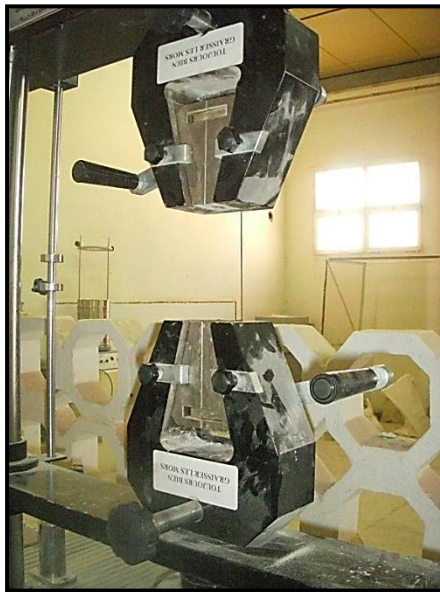
Annexe 7 : Essai de traction sur une fibre métallique.
