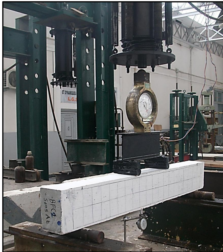
Dispositif de l'essai de flexion 4 point.
