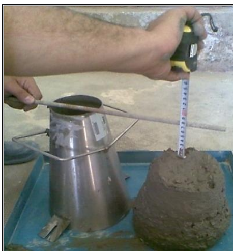
Figure (V-6) : Mesure de la consistance (Affaissement au cône d'ABRAMS).
