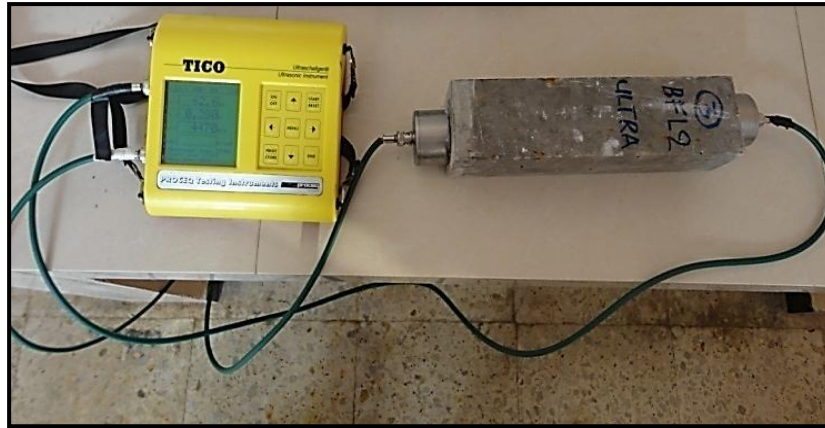
Figure (V-11) : Appareil d'Auscultation dynamique (ultra sonique).
