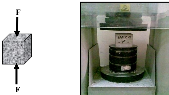
Figure (V-7) : Schématisation du dispositif de compression.
