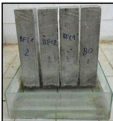
Figure (V-10) : Dispositif expérimental de l'essai d'absorption capillaire.
