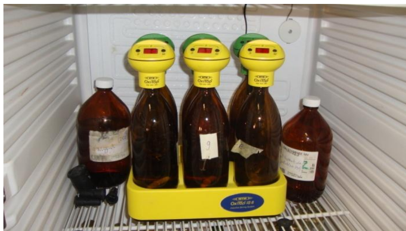
Photo (6): DBO-mètre pour la détermination de la DBO_5
