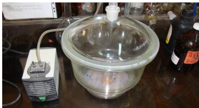
Photo (3) : Montage pour la détermination de la densité réelle
