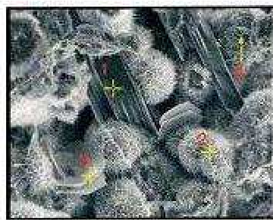
1: Portlandite, 2: C-S-H, 3: Aluminate de çà hydraté, 4:Ettringite.
