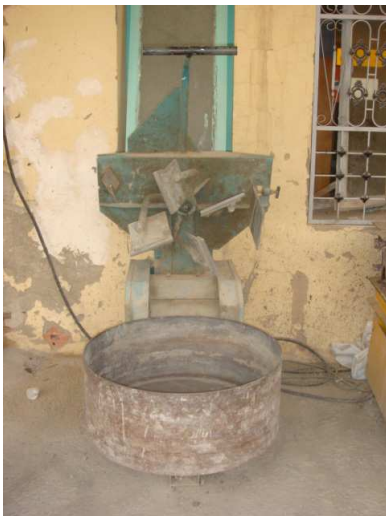
Photo V-9: Malaxeur ZYKLOS d'une cuve de diamètre 80 cm et 32 cm d'hauteur.
