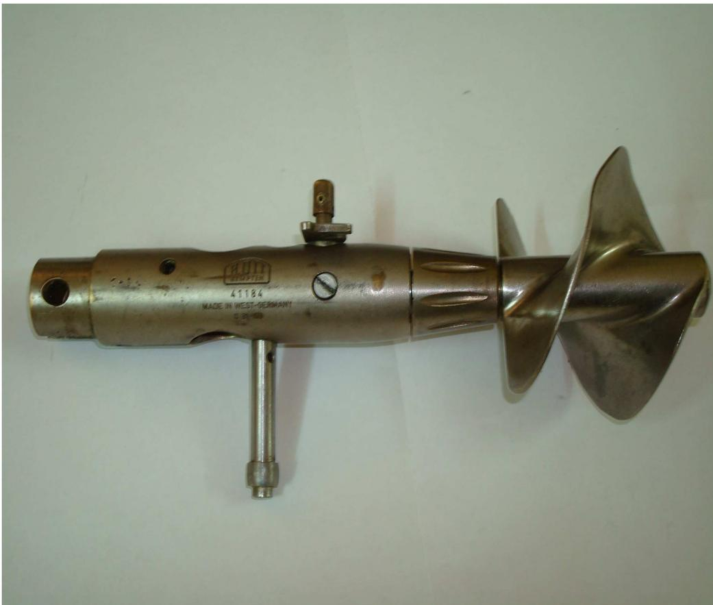
**Photo II.6 Type de moulinet utilisé au jaugeage**
