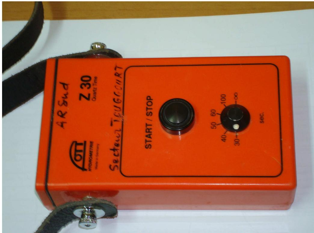
**Photo II.7 Compteur utilisé au jaugeage**
