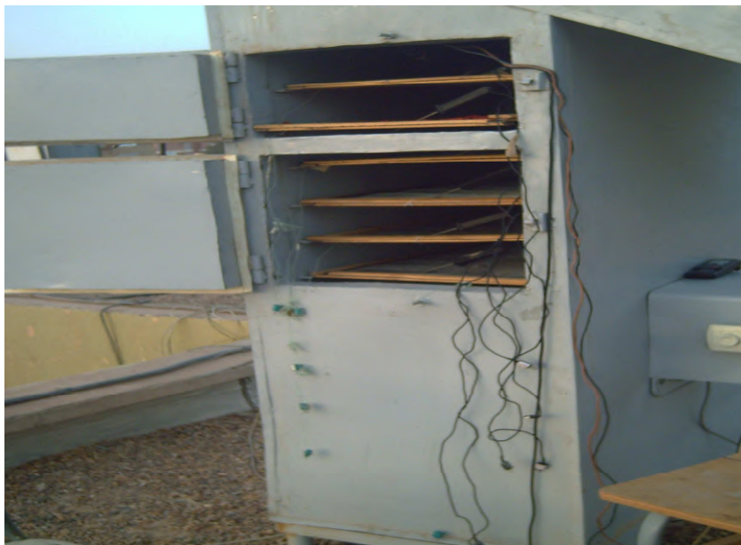
Les claies de la chambre de séchage
