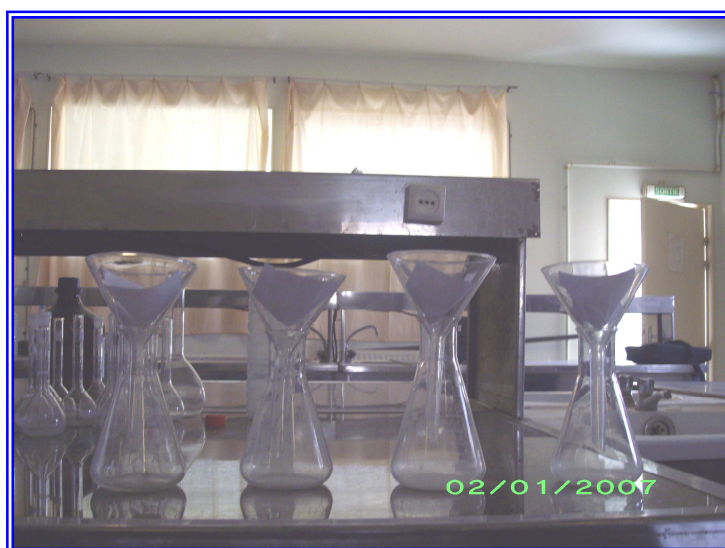
Photo 05: Filtration pour la détermination de MES
