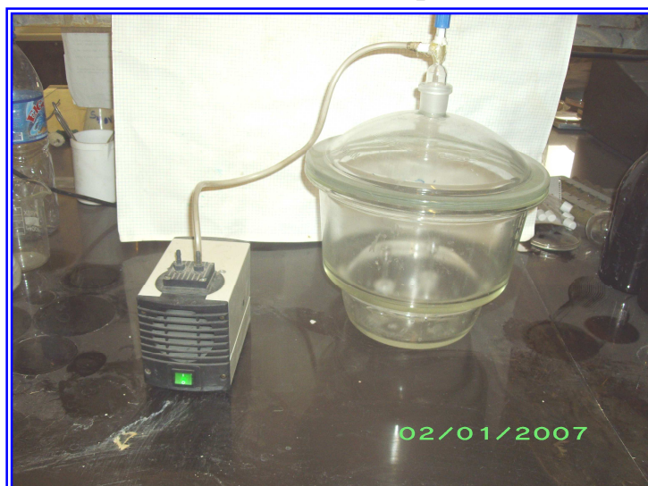
Photo 04: Montage pour la détermination de la densité réelle
