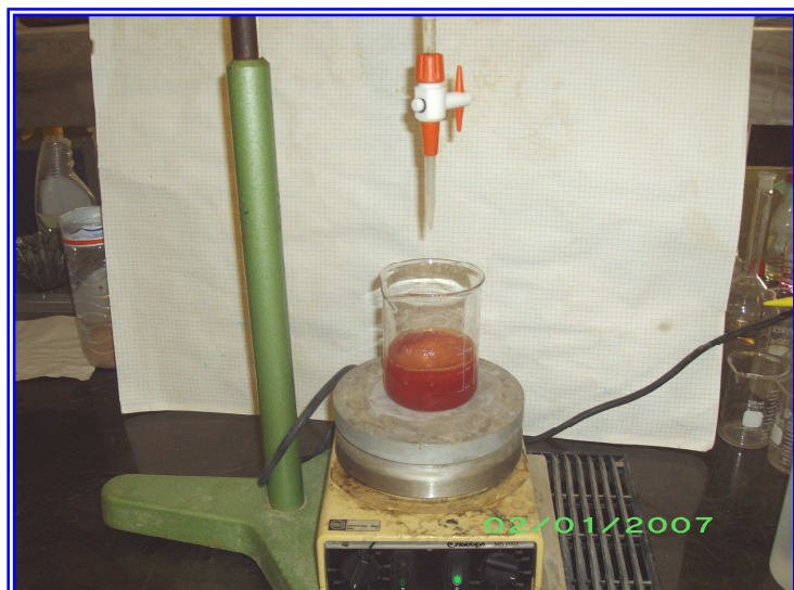
Photo 06: Titrage pour la détermination de la MO
