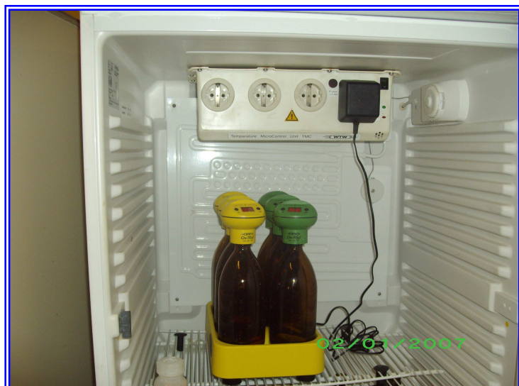
Photo 06: DBOmètre pou la détermination de la DBO 5
