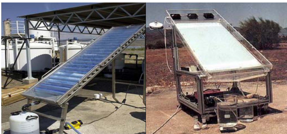
Figure (II-17) : Capteur solaire à non-concentration utilisant le catalyseur supporté. a) de type cascade, b) de type plan.
