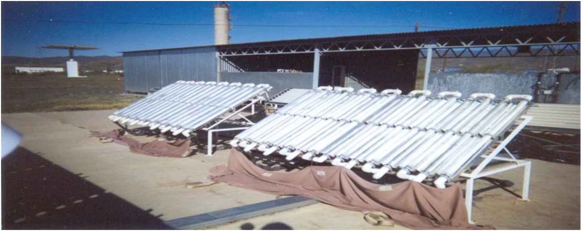
Figure (II-18): Pilote solaire (Photoréacteur à collecteur composé parabolique) utilisant des suspensions sur la plateforme permettant de dépolluer 300 litres d'eau par jour
