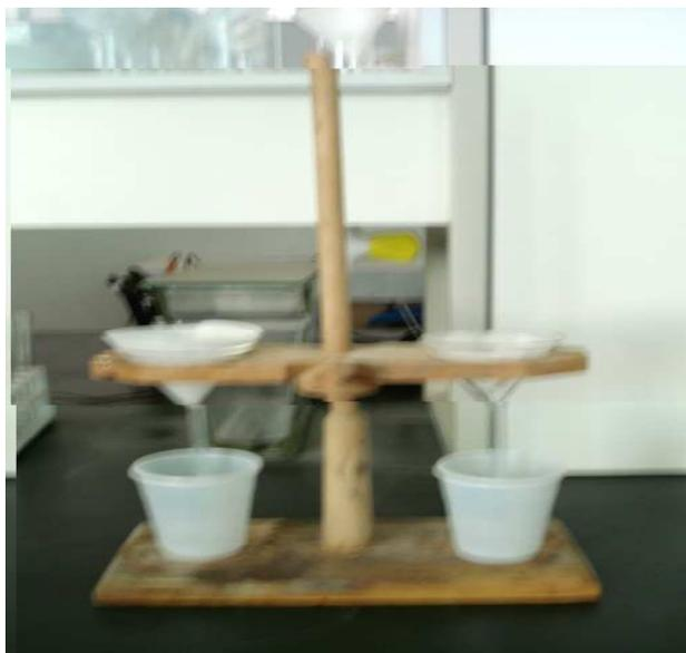
Après 3 minutes d'agitation et 10 minutes de réaction, la solution est filtrée sur un filtre millipore, suivi par l'analyse des ions fluorures (figure 20) ,(tableau 29 et figure 21).
