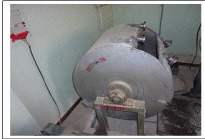
Photo 12: Essai de Los Angeles de gravier 8/15 au labo LTPS.
