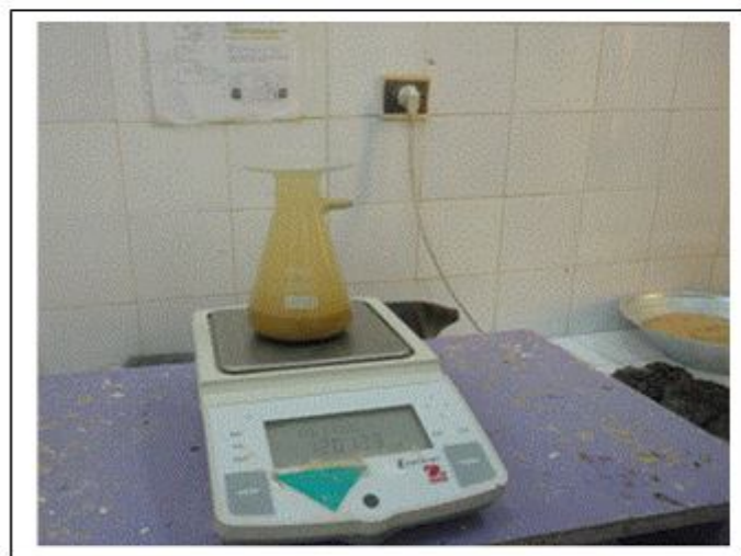
Photo 08 : Mesure de la masse volumique absolue du sable au labo LTPS.
