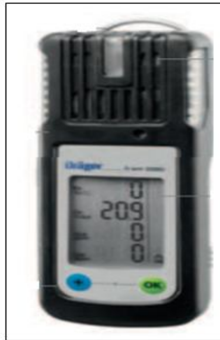
Photo (II, 01) : Détecteur portable de gaz H 2 S de matricule (Dräger X-am® 2000).
