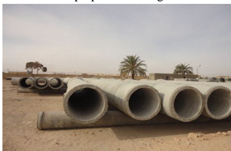
K : Conduites CAO après la fabrication
