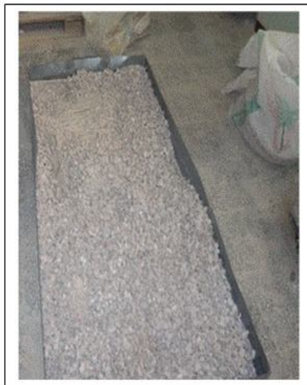
Photo (III, 01): Préparation des échantillons de gravier 8/15 au labo LTPS.
