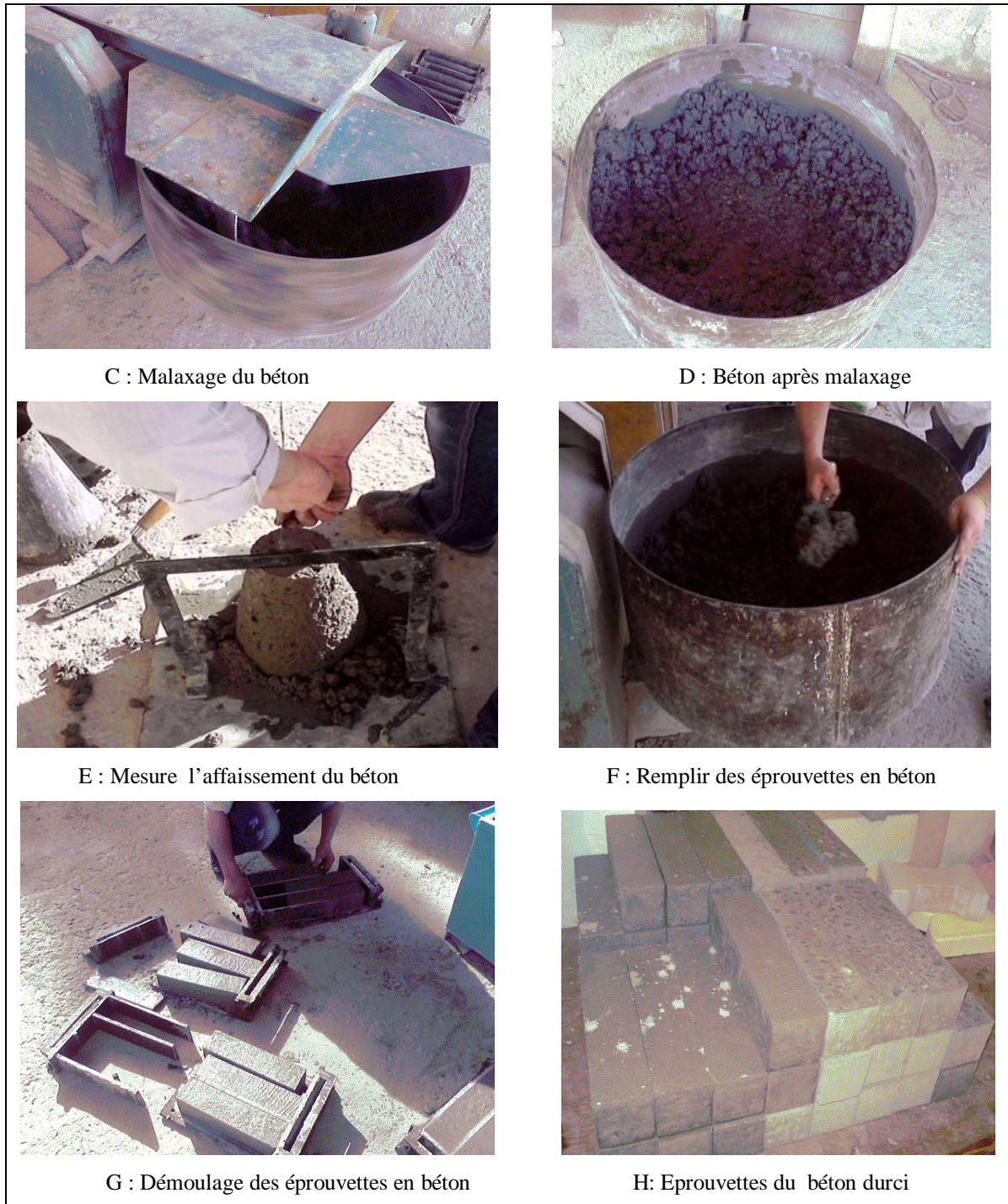
Photo (III, 07) : Confection des éprouvettes en béton ( 7 \times 7 \times 28 ) \text{cm}^3 au labo LTPS.
