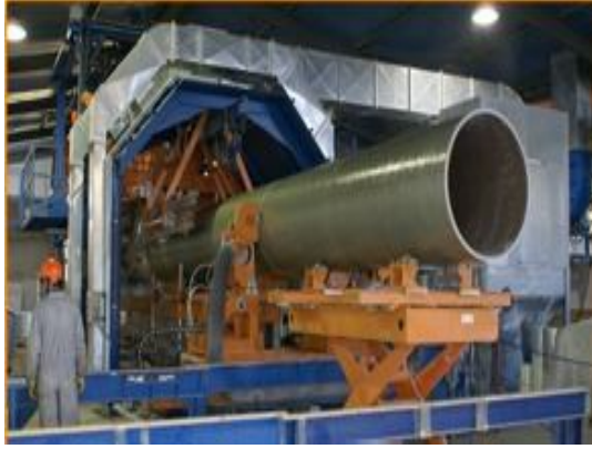
A : Fabrication par l'enroulement filamenteux continue.
