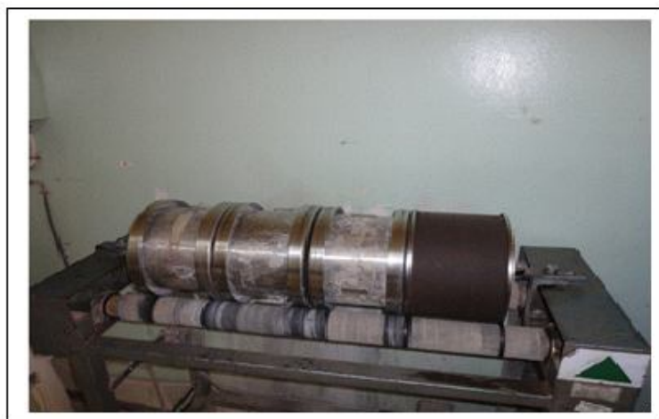
Photo 11 : Essai de friabilité de sable par la machine de MICRO-DEVAL.
