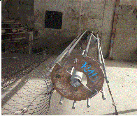
A : Machine d'enroulement des armatures de Ø 6
