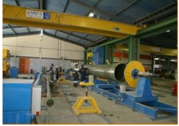
B : Fabrication par l'enroulement filamenteux discontinu.
