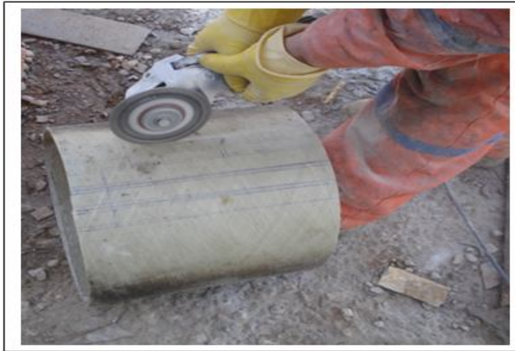
Photo 15: Coupe des échantillons en haut et en bas pour l'essai de traction et de flexion en trois points
