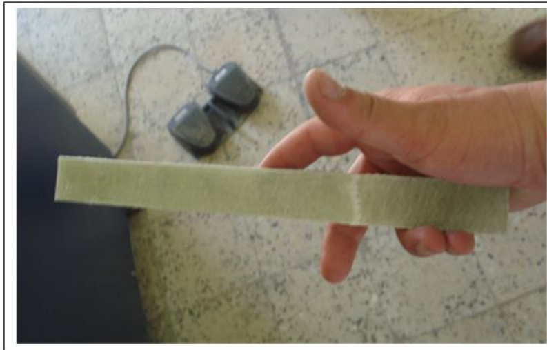
Photo 16: Echantillon après la rupture par l'essai de traction axiale
