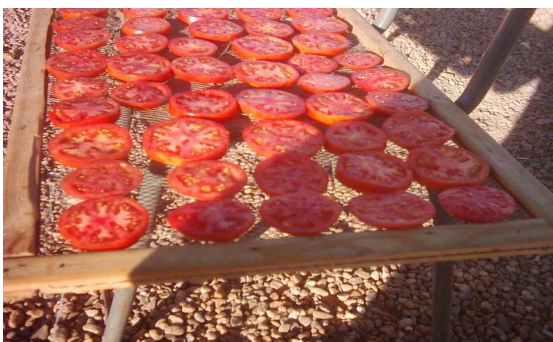
T=50 °C, V=1,5 m/s début de l'opération de séchage
