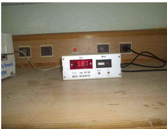
Solarimeter (de type DS 120)
