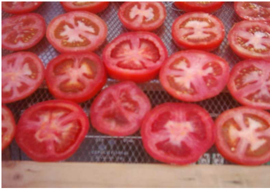
T=50 °C, V=1 m/s début de l'opération de séchage
