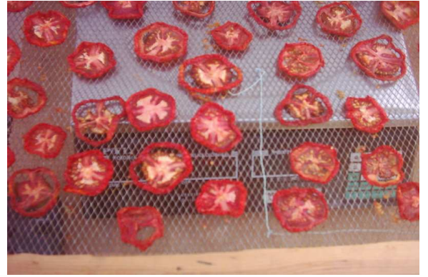
T=50 °C, V=1 m/s fin de l'opération de séchage
