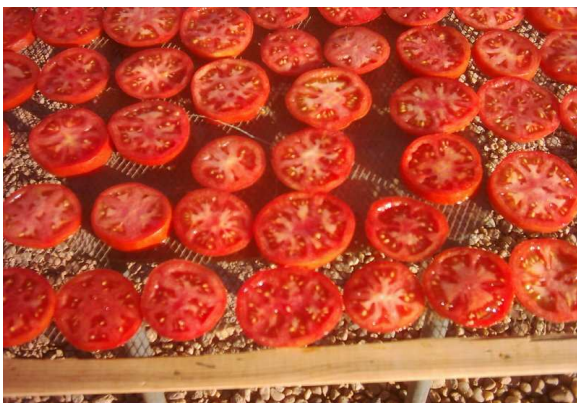
T=65 °C, V=2 m/s début de l'opération de séchage
