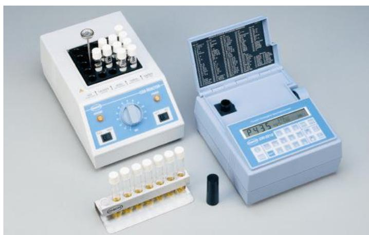
**Figure. IV.1: Spectrophotomètre de type DR-2000**
