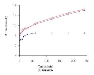
Fig. 1: Effet du temps de contact sur la chloration de bases organiques en eaux minéralisées à pH=7.
