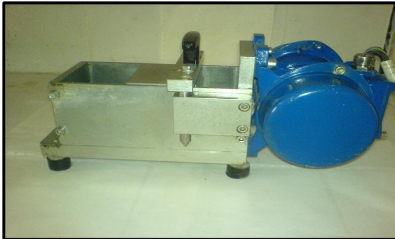
**Photo II.4.** Maniabilimètre B (180x90x90mm).
