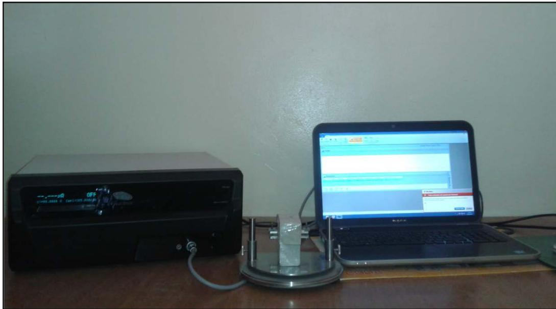
**Photo II.7.** Mesure de propriétés thermiques à l'aide du système «Hot Disk».
