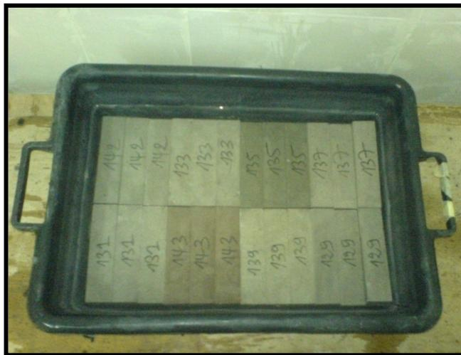
**Photo III.2.** Mode de conservation des éprouvettes.
