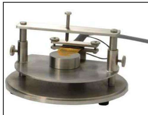
**Photo II.9.** Dispositif de serrage.
