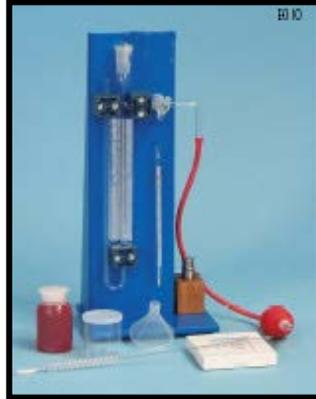
**Photo II.1.**Perméabilimètre de Blaine.
