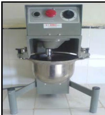
**Photo.III.1.** Malaxeur normalisé pour pâte et mortier.
