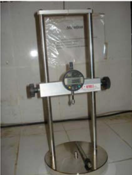
Photo II.6. Appareil de retrait utilisé.
