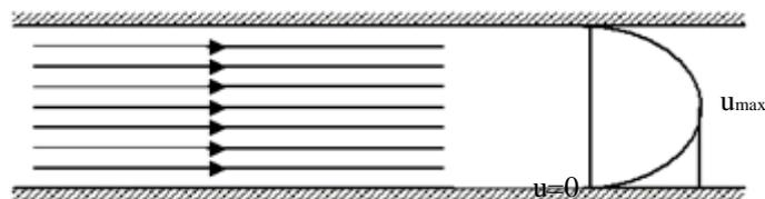
**Fig. I.3 : Ecoulement laminaire**
