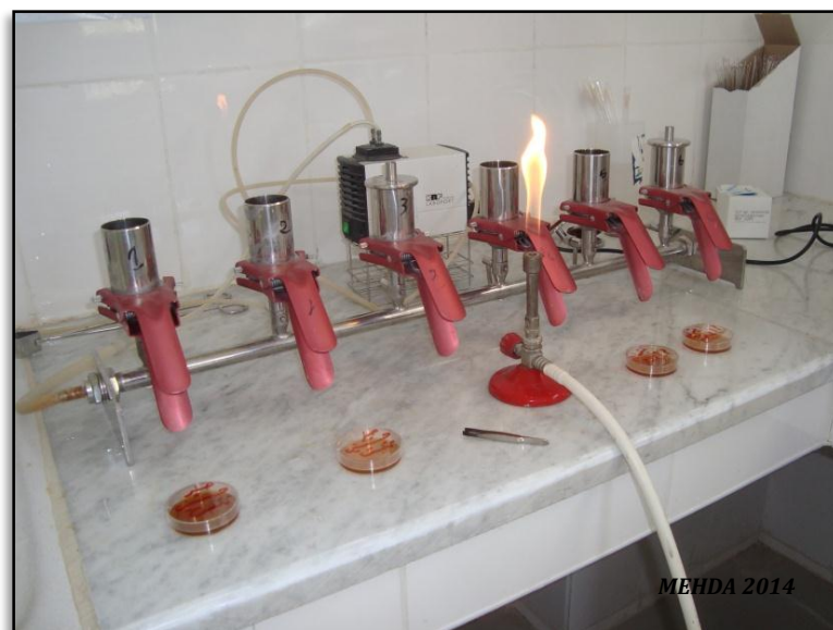
Photo 05 : La rampe de filtration.
