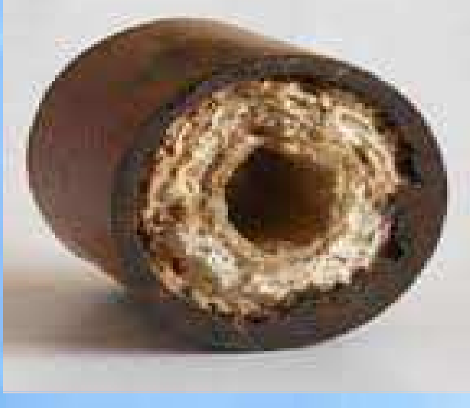
انسداد القنوات من مشاكل رداءة نوعية المياه
