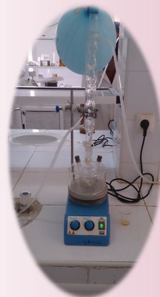
Montage de synthèse à reflux
