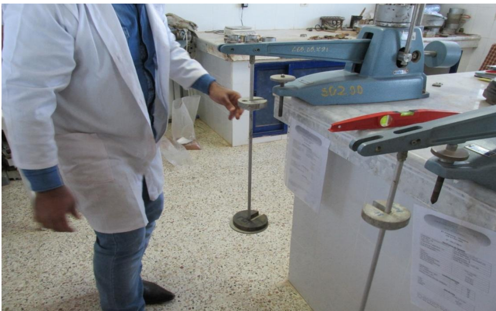
Photos V- 3: système d'application des charges sur l'Oedomètre
