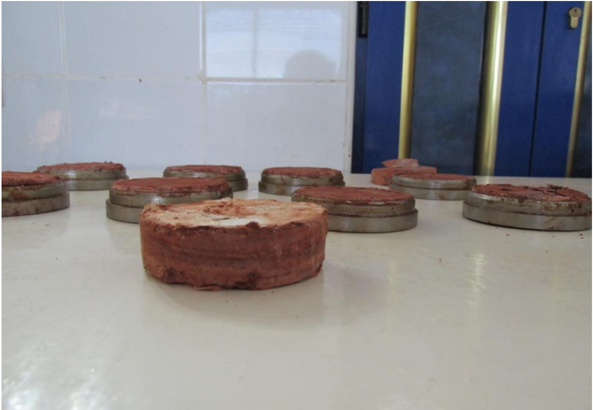
Photos V- 4: les éprouvettes de l'argile d'In Amenas récupérées à la fin de l'essai
