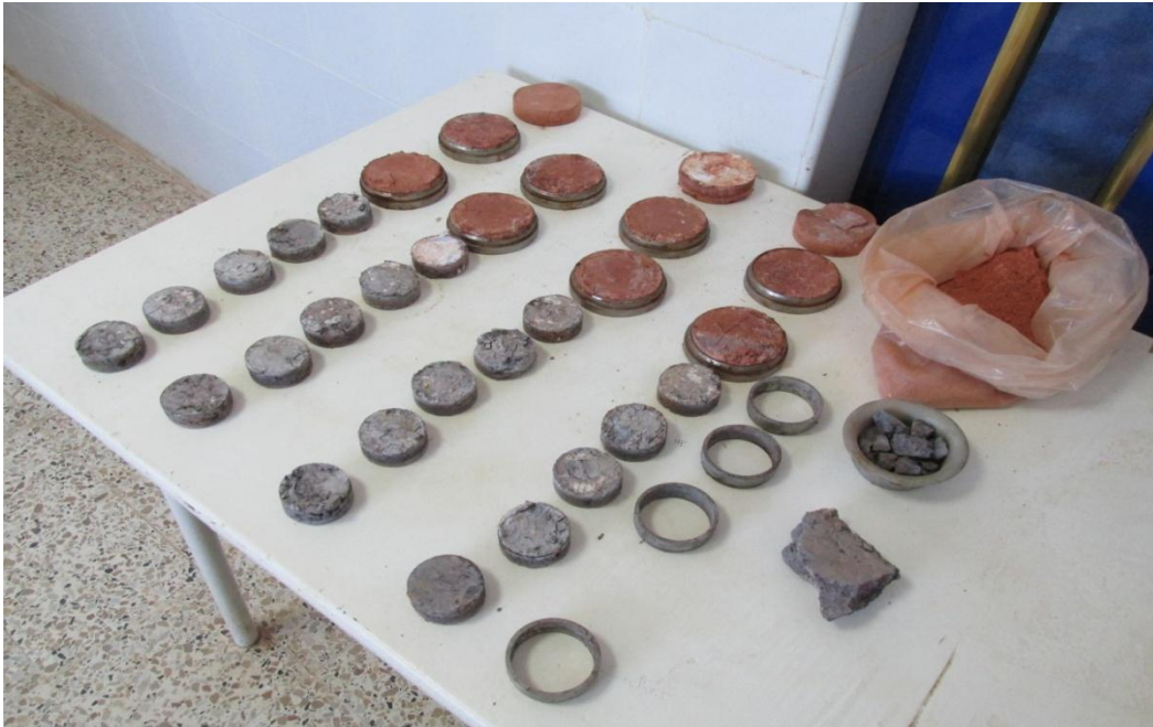
Photos V- 2 : les éprouvette confectionnées à partir des échantillons des deux argiles (la rouge argile d'In Amenas et la violée Celle d'In Salah)
