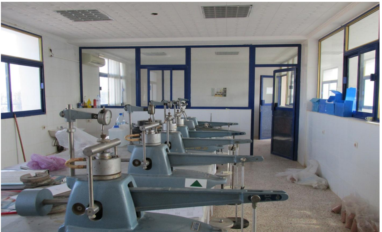
Photos V- 1 : les oedomètres utilisés pour les essais de gonflement (salle de M.D.S au niveau du L.T.P.Sud à Ghardaïa)
