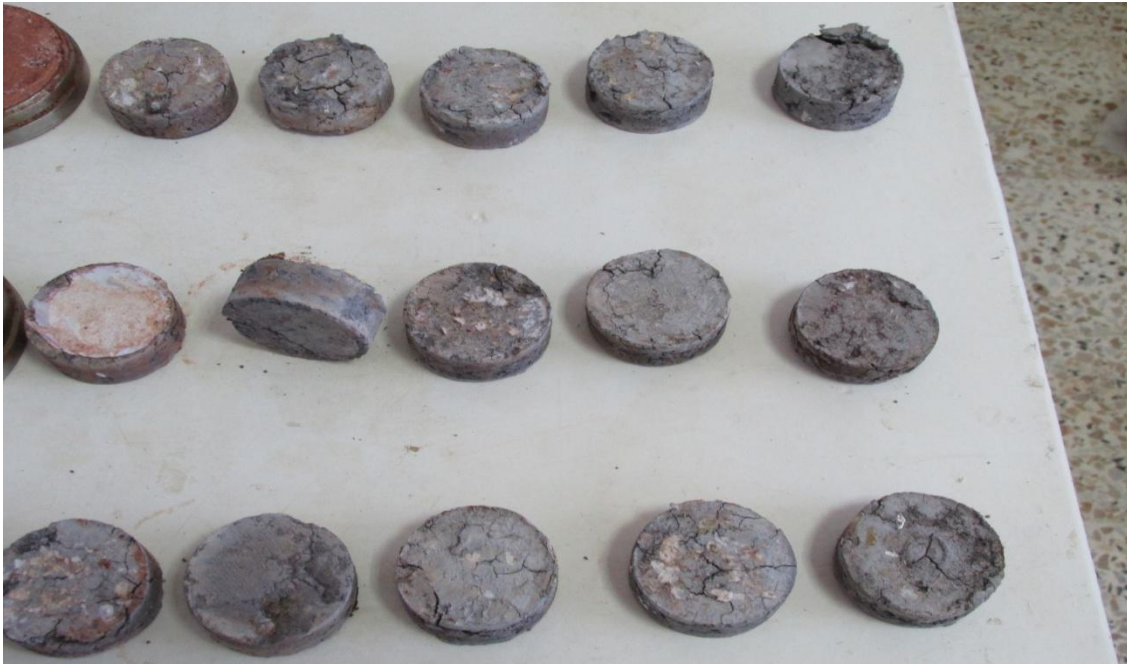
Photos V - 5 : les éprouvettes de l'argile d'In Salah récupérées à la fin de l'essai
