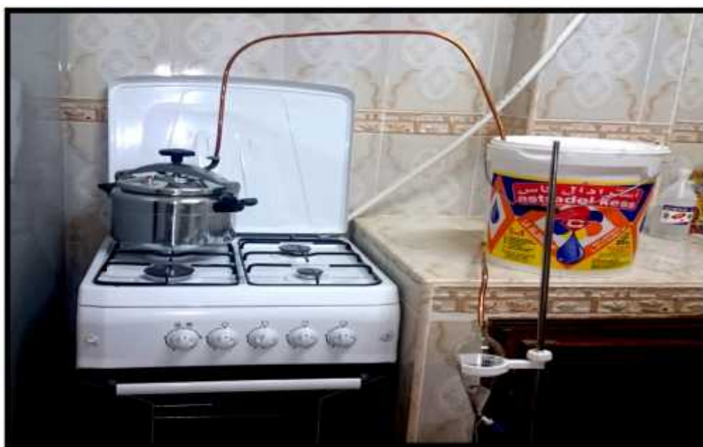
Image 02: Montage d'hydrodistillation traditionnelle employé pour l'extraction de l'huile essentielle de Pélargonium graveolens
