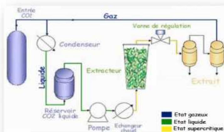
Figure 06 : Montage d'extraction par CO 2 supercritique
