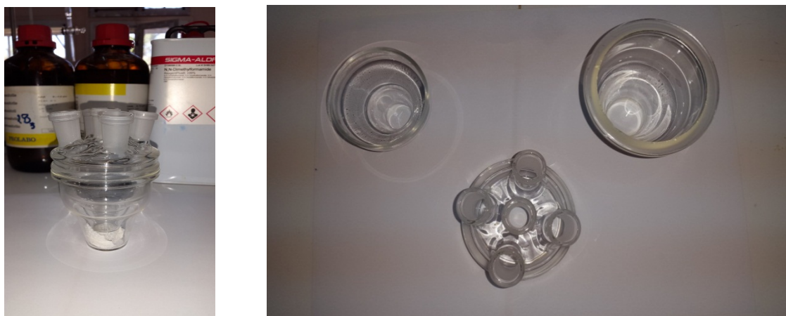
Photo 1): cellule de voltamétrie cyclique à 3 électrodes (avant montage)
