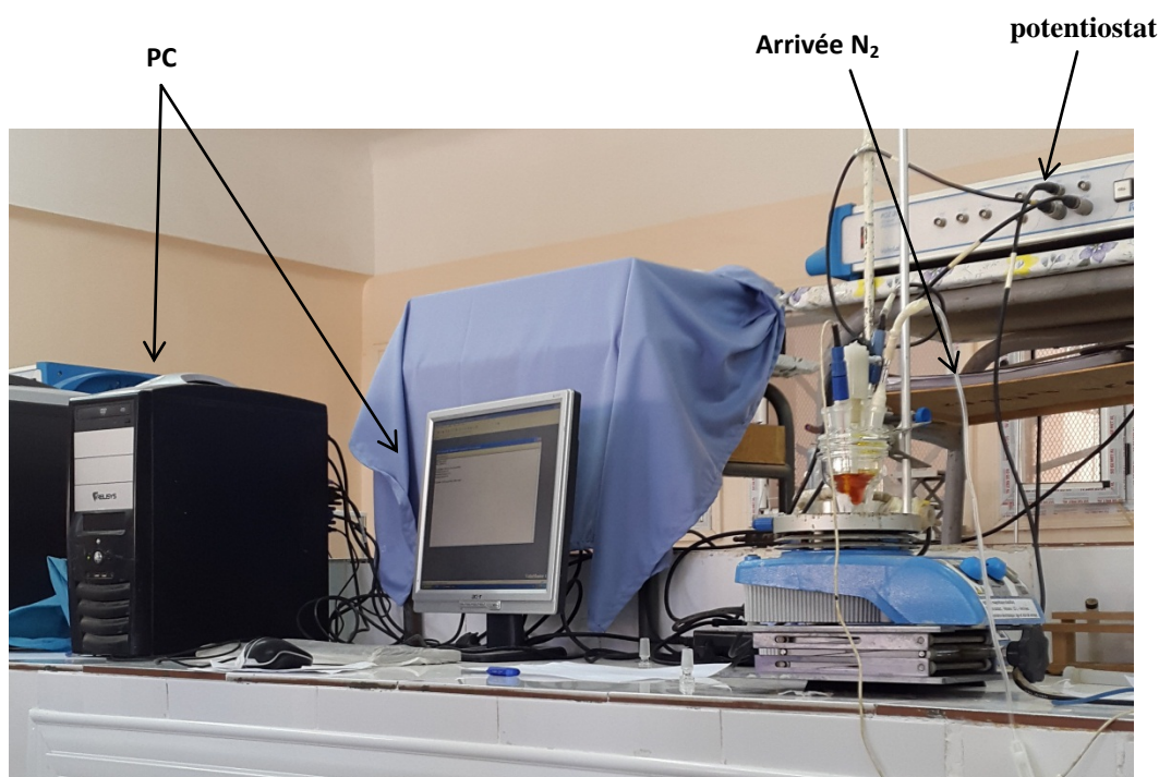
Photo 5) Equipements électrochimie utilise dans le travail
