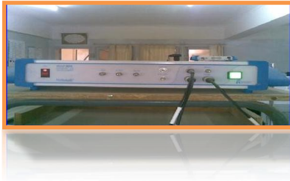
الصورة-7- : يوضح جهاز Potention-Galvanostat من نوع PGZ301
