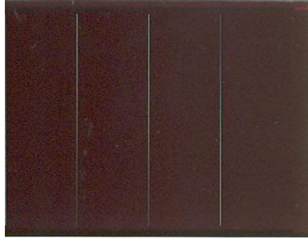
الشكل (3.3): لوح شمسي مصنوع من خلايا سيليكونية عشوائية.
