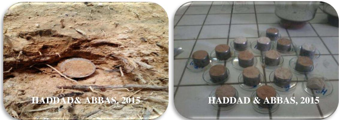
**Photo 6.** Mesure de la densité apparente sur terrain et au laboratoire
