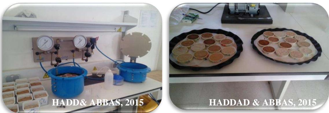
**Photo 7.** Mesure de l'humidité par l'appareil de RICHARD au laboratoire
