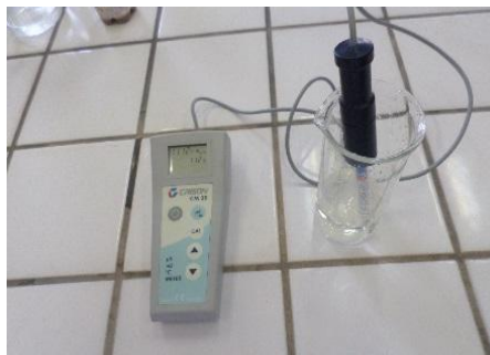
Photo N° 6 : Mesure de la CE du sol
