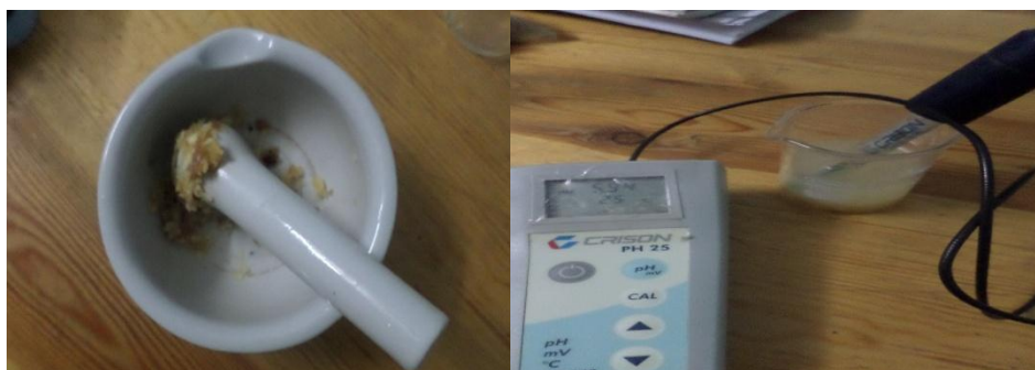
Photo N°4 : Broyage des dattes au mortier et Mesure du pH des dattes au pH-mètre
