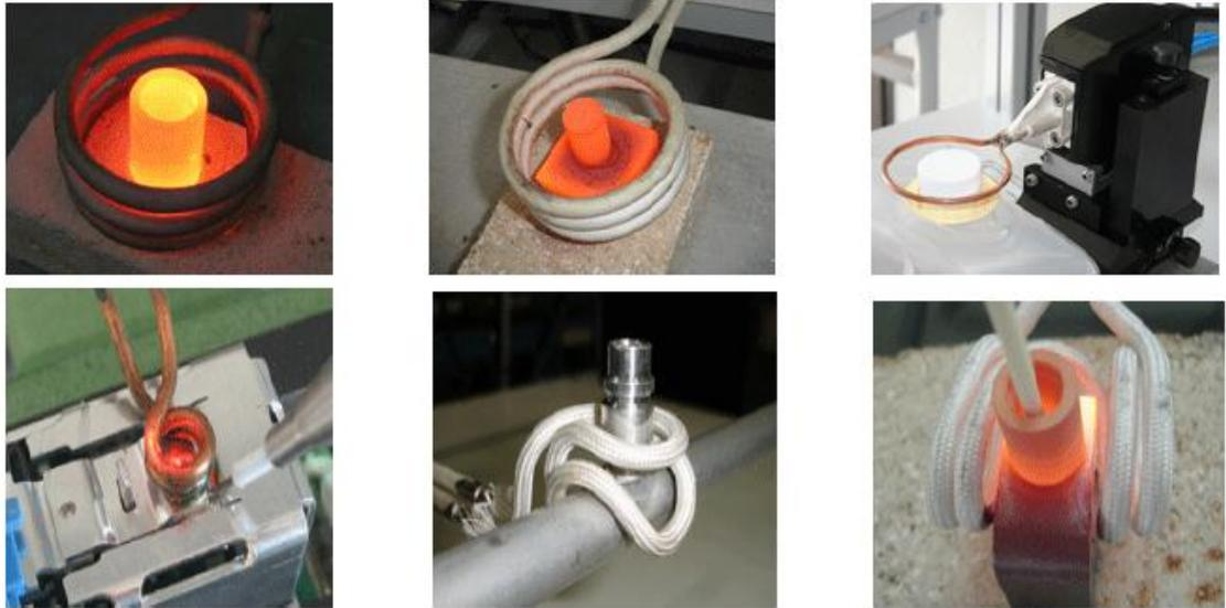
**Figure 1.6:** chauffages par induction avec des inducteurs de formes différentes. [08]
