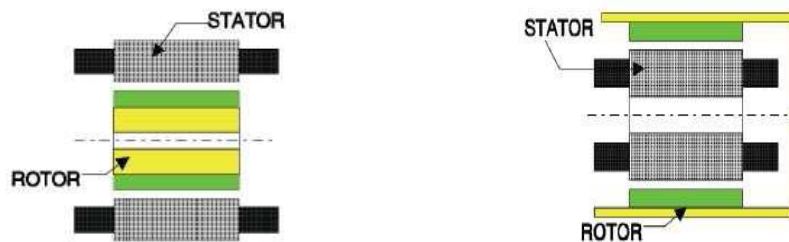
Figure I.11 Moteur à rotor intérieur et extérieur.
