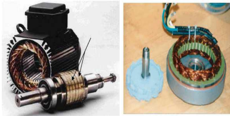
Figure I.9: Moteur à aimants en géométries cylindriques
