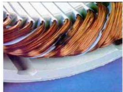
Court-circuit dans une phase
