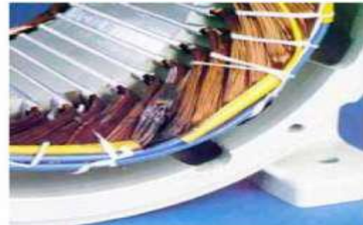
Masse dans l'encoche Dégradation causée par une surtension
