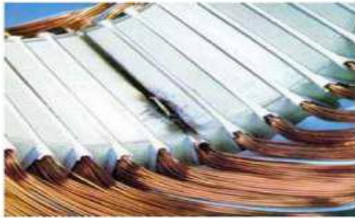
Masse dans l'encoche Dégradation causée par une surtension
