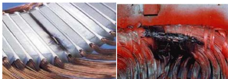
Fig I.2: Représentation des différents défauts statoriques possibles
