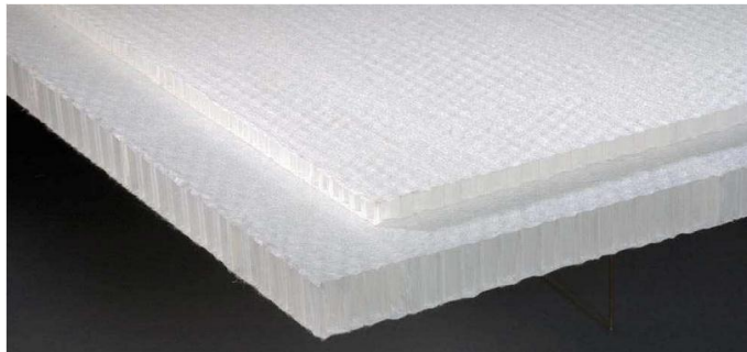
Figure I.9 : Structure en nid d'abeille polypropylène [7].
