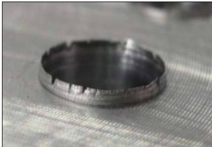
Figure I.24 Exemple de bavure formée à la débouchure d'une couche d'aluminium.[6]
