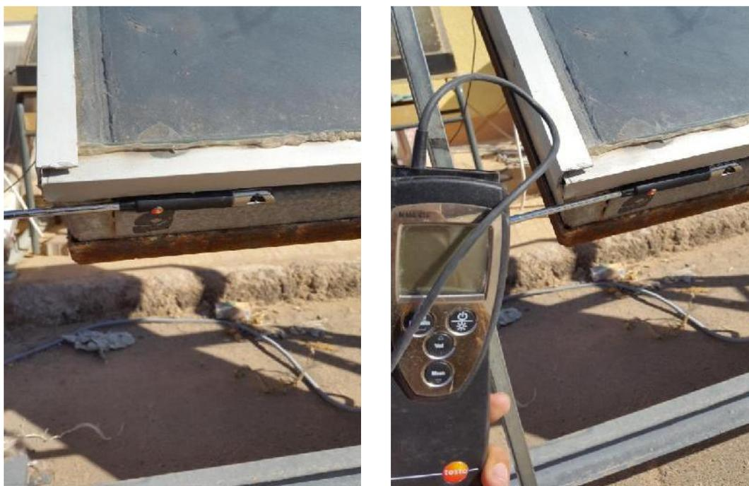
*Fig. (III-10) : Anémomètre (Testo 416)*
