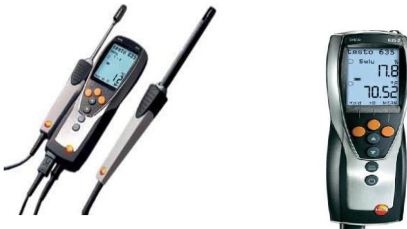
*Fig (III-9): Anémomètre Thermo-hygromètre (Testo 635)*
