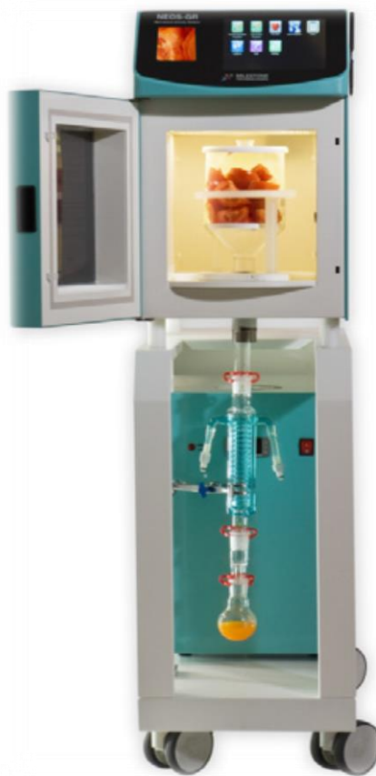
Fig.8. L'extraction par micro-ondes combinant l'hydrodiffusion et la gravité [6]
