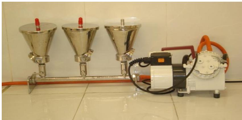
**Photo (09): Dispositif de filtration sous vide**
