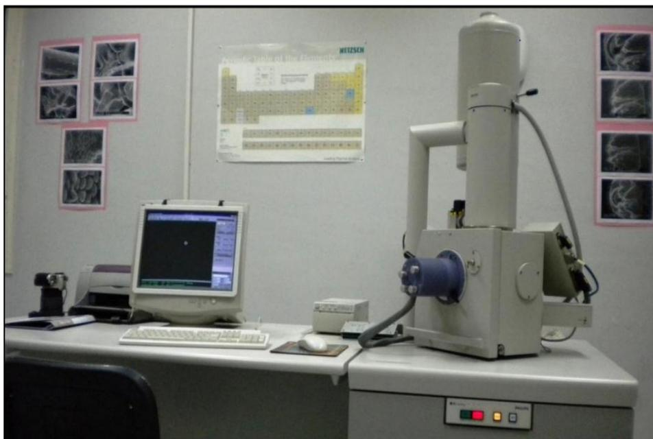
**Figure :** Appareil microscopie électronique à balayage de type PHILIPS ESEM XL30
