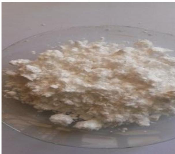
**Fig.III. 1:** La poudre de Dodécylsulfate d'anilinium (ADS) préparée
