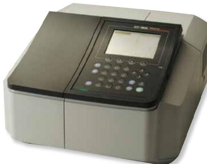
Figure 25 : le spectrophotomètre UV/vis Lamarque : UV-1800/shimadzu, UV-VIS, entre 200 et 900 nm
