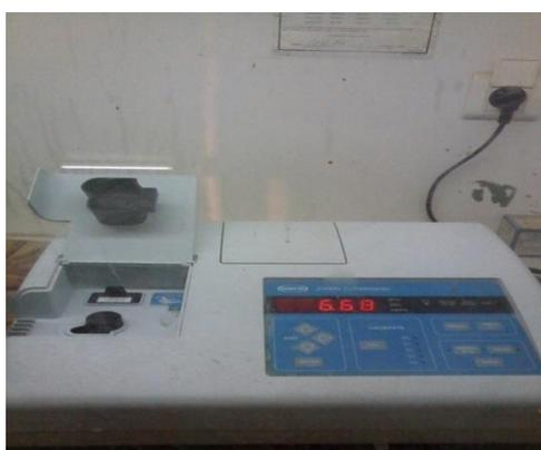
Figure (IV.1) : Turbidimètre
