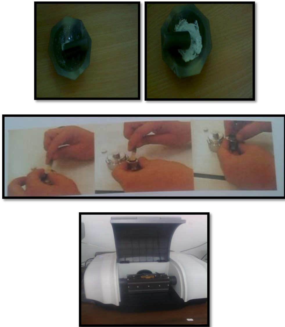
Figure IV.6.les étapes d'un spectrophotomètre IR
