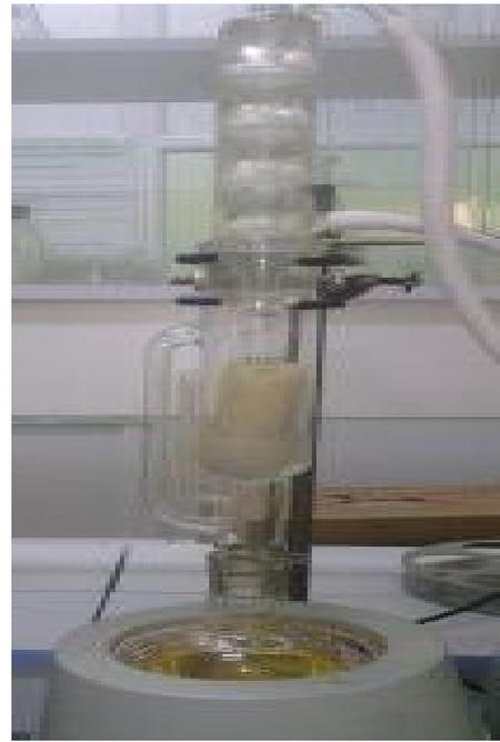
Fig. IV.1. Schéma et Montage d'un appareil de Soxhlet
