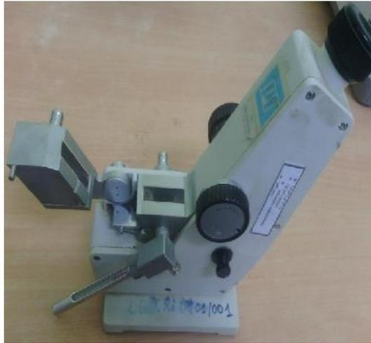
**Fig. IV.2.** Le réfractomètre d'ABBE.
