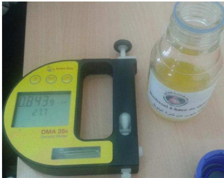
Fig. IV.8. Densimètre de type DAM 35 biodiesel
