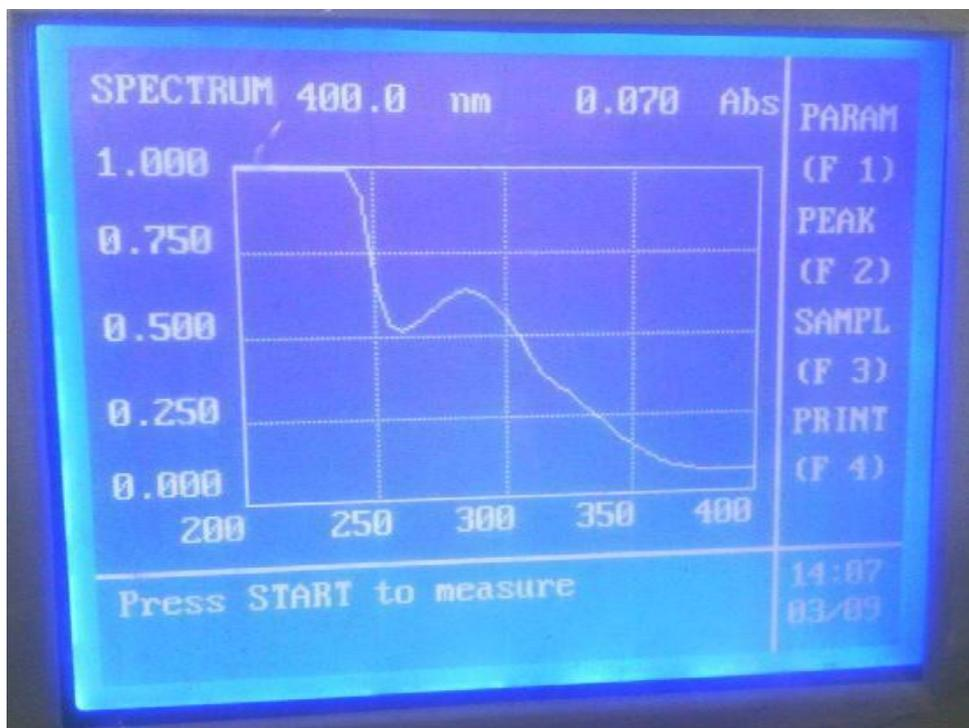
**Fig. IV.6** .spectre UV –Visible d’huile de chêne
